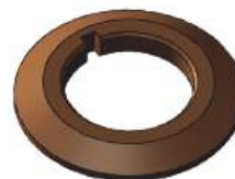
Espaçador Calço Diâmetro Ext.: 66,67mm Diâmetro Int.: 38,10mm Espessura: 8,00mm
