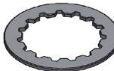
Arruela Diâmetro Ext.: 79,30mm Diâmetro Int.: 53,9/61,3mm Espessura: 3,00mm 15 Dentes Interno
