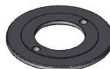
Arruela Diâmetro Ext.: 126,00mm Diâmetro Int.: 60,50mm Espessura: 7,60mm
