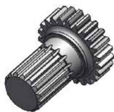
Eixo Transmissão Comp. Total: 110,00mm 15/23 Estrias
