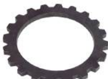
Arruela Diâmetro Ext.: 87,0/79,0mm Diâmetro Int.: 62,48mm Espessura: 4,60mm 20 Dentes Externo
